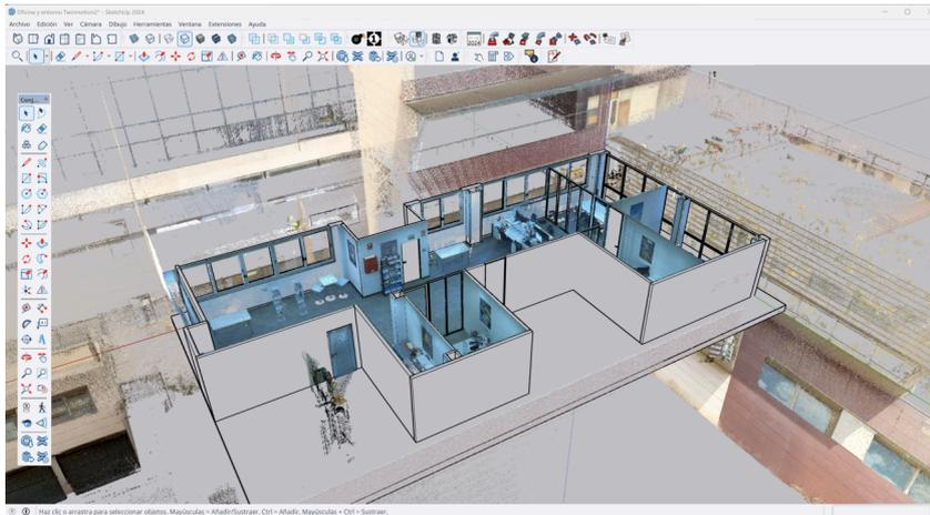
Durante la sesión se mostrará el procedimiento a seguir para la realización de un modelado 3D del estado actual de una edificación para su posterior utilización en un proyecto de reforma, ampliación, rehabilitación, demolición u obra nueva.
