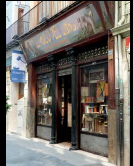
Los bajos comerciales continúan haciendo uso de las columnas de fundición para conseguir mayor diaphanidad en edificios preexistentes, como en este caso, y recurren a diseños corporativos procedentes del taller del ebanista que incorporan cuadernas, coup de fouet y tallas decorativas vegetales. Calle San Fernando 14
