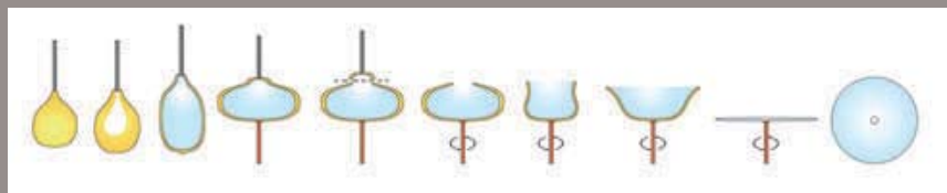
Proceso de fabricación del vidrio de corona o de disco
